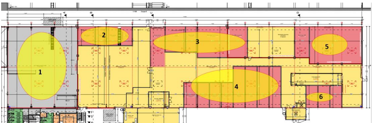
Répartition du zonage des alarmes incendie
